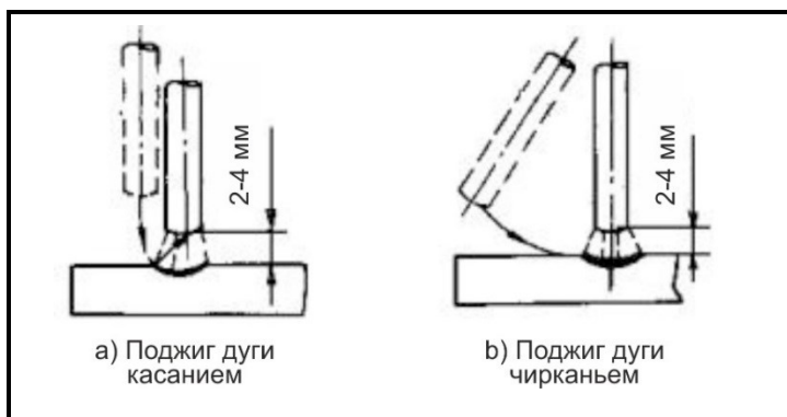
Рисунок 13.3. Способы поджига дуги.
